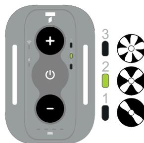
**Safety First :** Le moteur s'arrête lorsque la télécommande est éteinte, ou dès lors que la liaison n'est plus assurée (en cas de chute par exemple).
